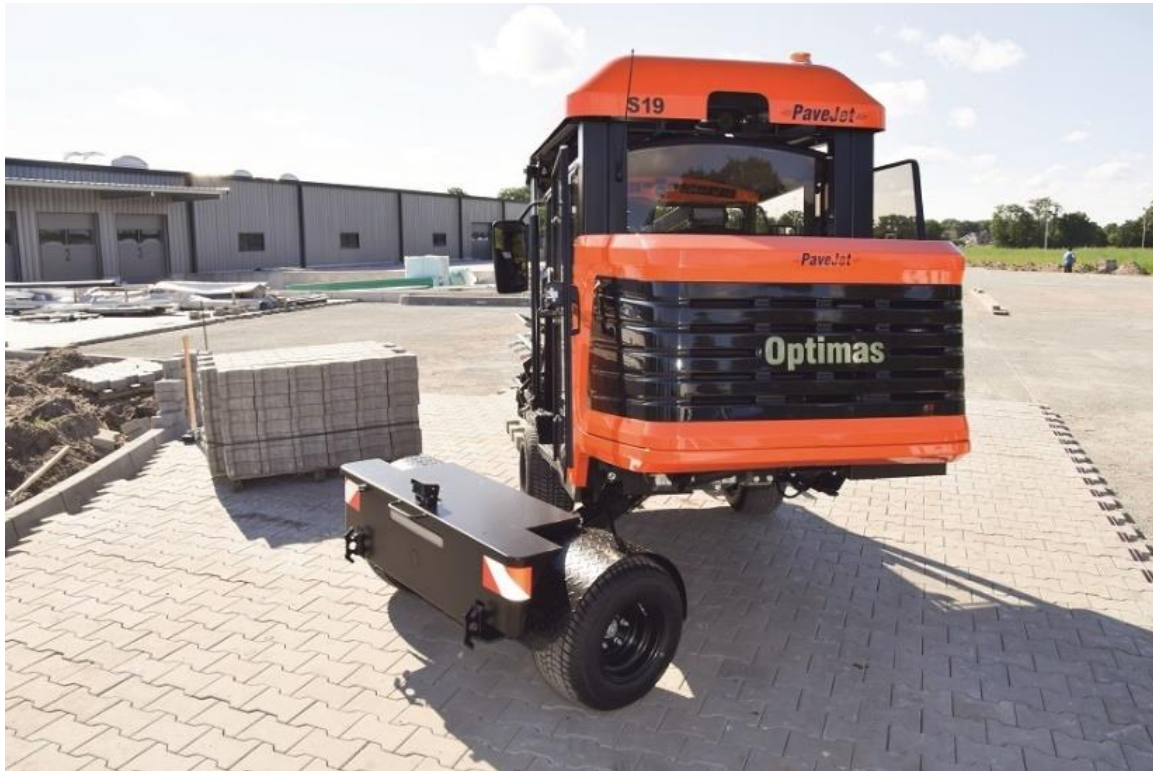
Bild 11: Verlegemaschine mit Zweiachs-Dreh-Schemel-Lenkung [Foto: Optimas]
