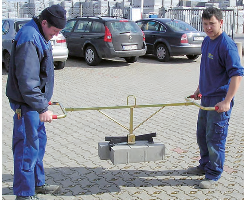
Modifizierte Bordsteinzange für hohe Versetzleistung mit 2-zeiligen Water-Line Pultrinnen.
