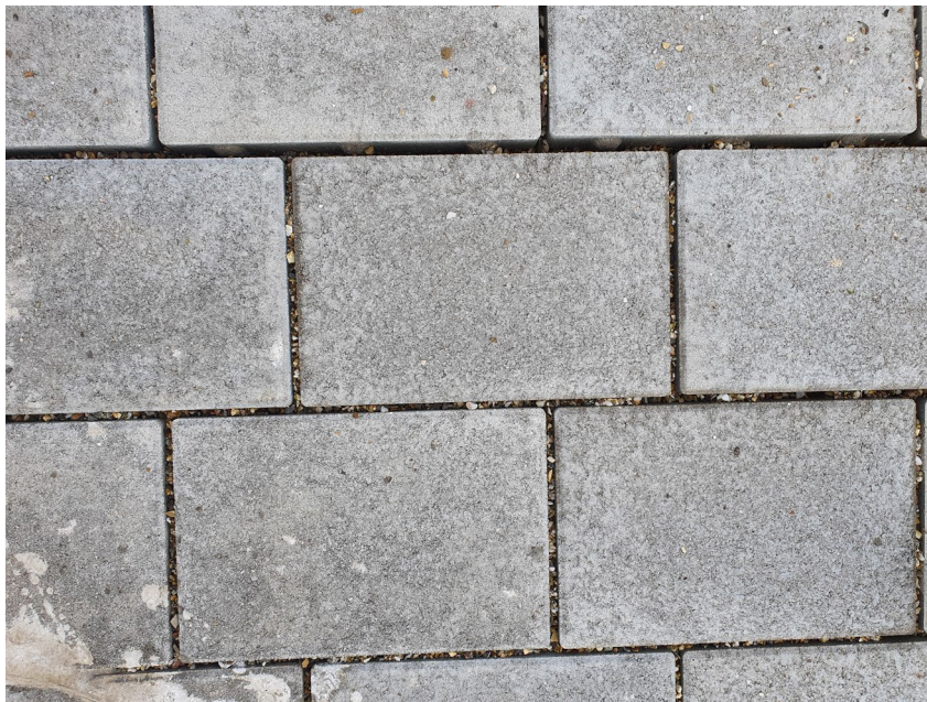
Bild 2: Draufsicht Prüffläche „Pasero 30/20/6 im Läuferverband“
