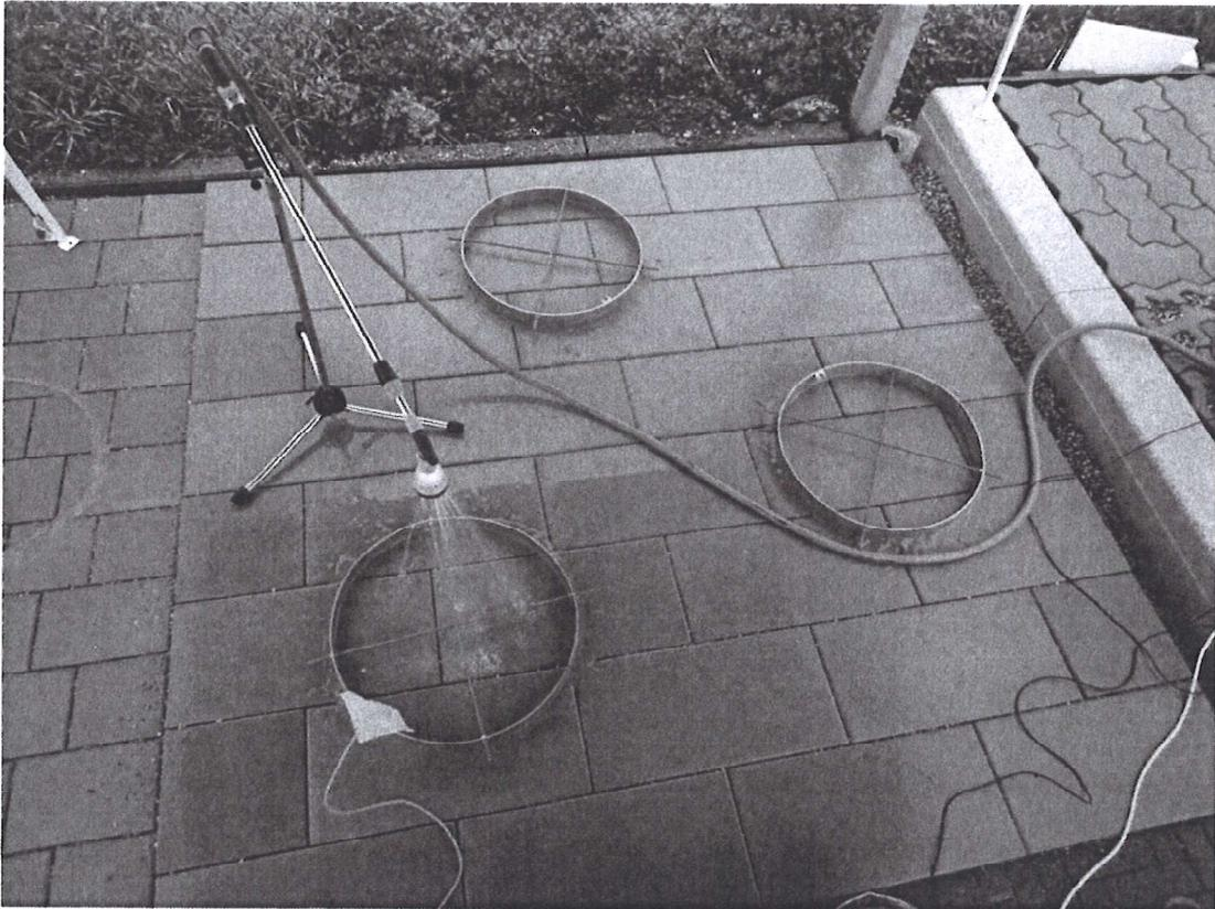
Bild: City Truck, Läuferverband Halbversatz, 60x30x10 cm, Versuchsdurchführung
