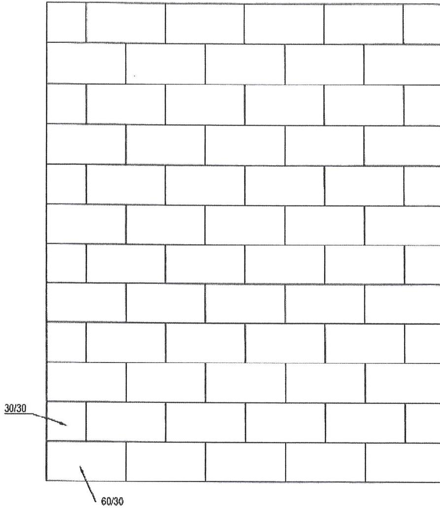
Bild: City Truck, Läuferverband Halbversatz, 60x30x10 cm
